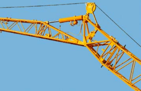
Hydraulisch verstellbare Klappspitze (0°- 40°)
